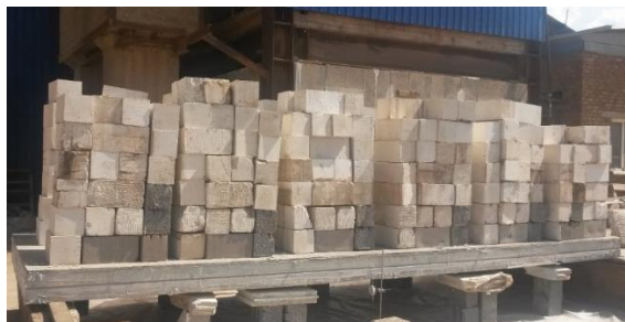
Рис. 9. Испытание опытной плиты на производственной базе «УГК»
